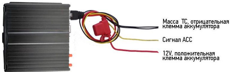
Рисунок 6 – Подключение питания к видеорегистратору
