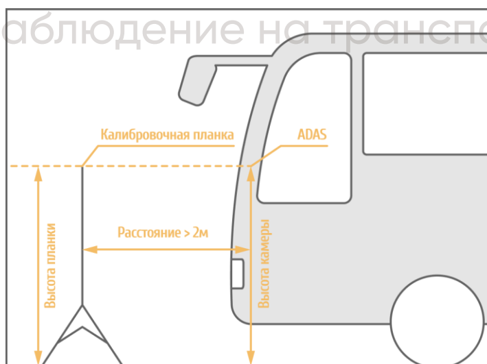
Рисунок 12 – Расположение калибровочной планки
