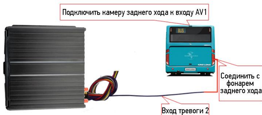
Рисунок 14 – Подключение тревожного входа к питанию фар заднего хода
