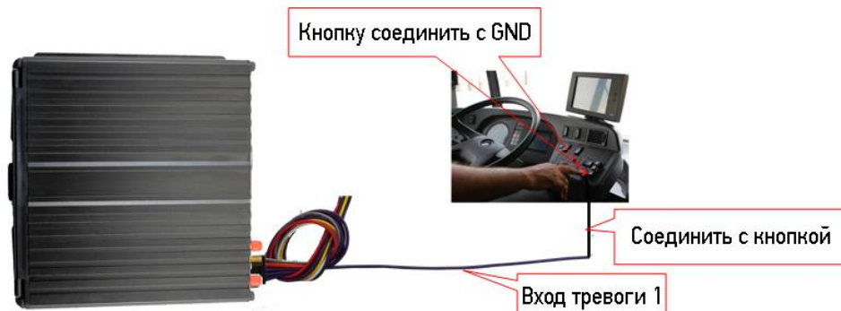
Рисунок 16 – Подключение тревожной кнопки
