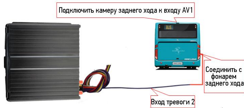
Рисунок 12 – Подключение тревожного входа к питанию фар заднего хода
