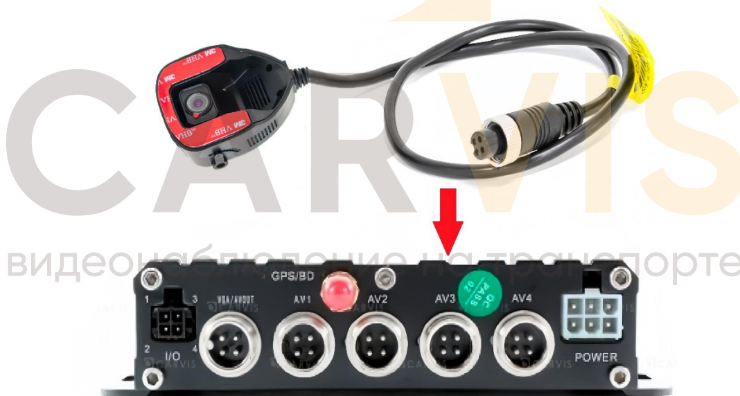
Рисунок 3 – Подключение камеры к автомобильному регистратору CARVIS (прямое подключение)
