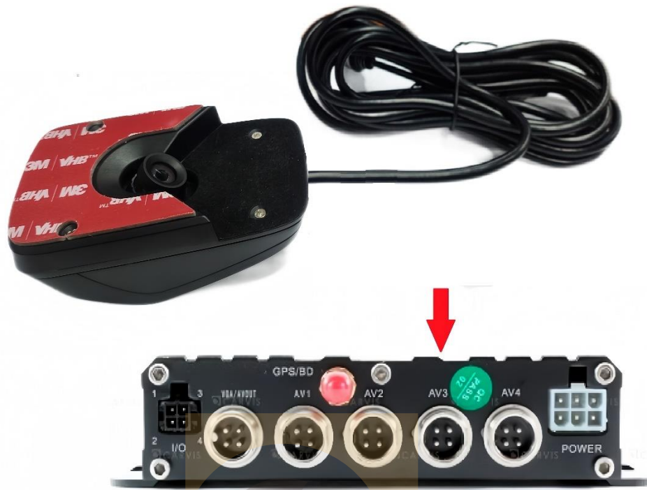
Рисунок 4 – Подключение камеры к автомобильному регистратору CARVIS (прямое подключение)
